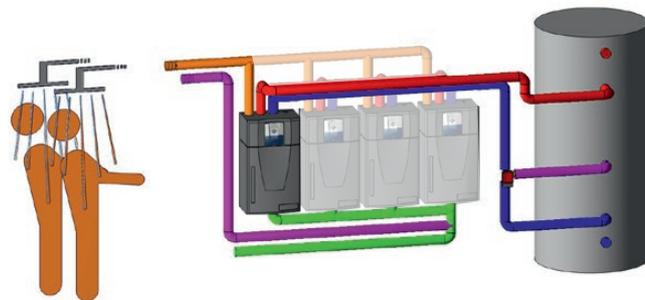
**Volllast:** Unter Volllast sind schließlich alle Kaltwasserventile geöffnet und alle Geräte arbeiten parallel. Nimmt die Warmwasserlast ab, so werden die Ventile der Rangfolge nach wieder geschlossen.
