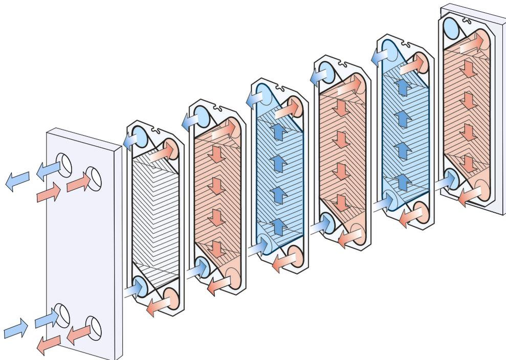
Abbildung 2: Beispiel einer Konfiguration mit einem Durchgang
