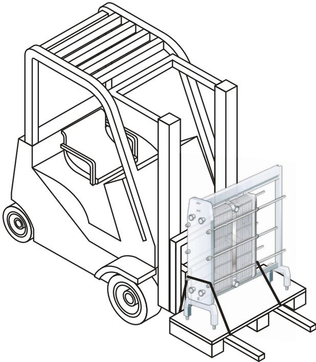
Vor dem Lösen der Ausrüstung von der Palette, die Ausrüstung mithilfe von Hebegurten gegen Herabfallen sichern.
