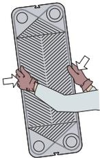
Plattenstapel durch Verschieben der Druckplatte auf der Tragstange öffnen.
