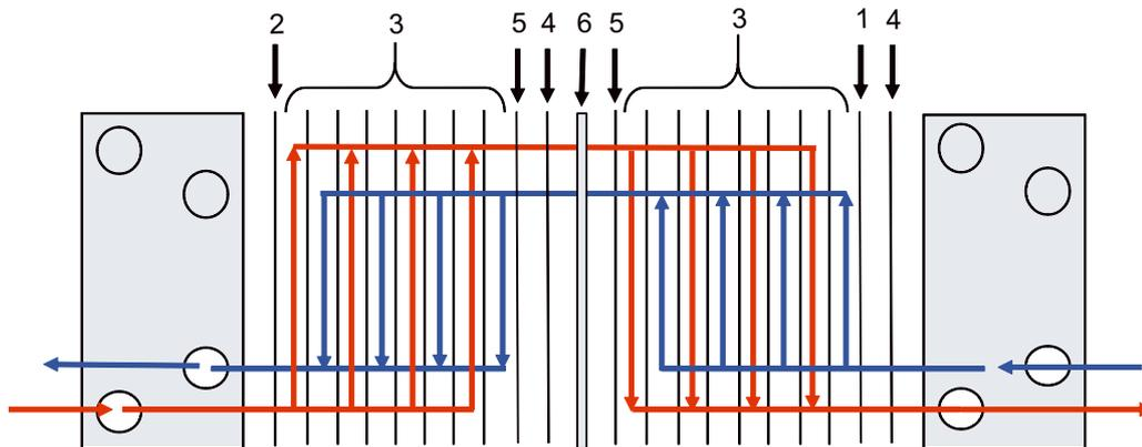
Abbildung 3: Beispiel eines Setups mit mehreren Durchgängen.
