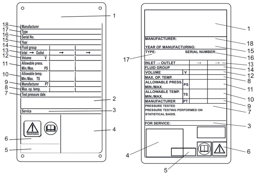
**Abbildung 1: Beispiel des Metalltypenschildes auf der linken und dem Typenschildaufkleber auf der rechten Seite.**
